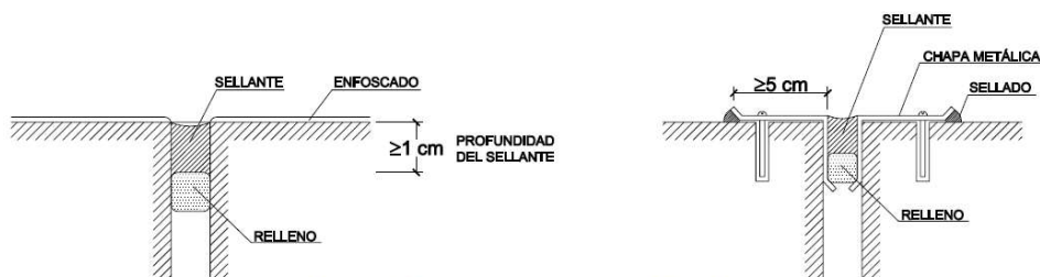
Figura 2.6 Ejemplos de juntas de dilatación
